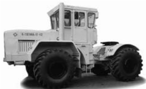
Рис. 16. К-700 «Кировец» – колесный трактор общего назначения повышенной проходимости, тяговый класс 5. Главный конструктор Ж. Котин. Выпускался Кировским заводом с 1964 по 2002 год (общий выпуск К-700, К-701, К-702, К-703 – около 400 тыс. экз.). В качестве прототипа для первой модели был использован канадский трактор Wagner
